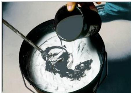
Étape 2 - Si nécessaire, colorer avec nos peintures indiquées dans l'échantillon et mélanger avec le batteur; laisser reposer pendant 24 heures.
